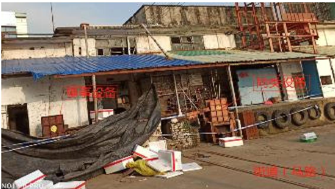
2、涉事设备碎冰机的基本情况。涉事设备是一台单齿辊碎冰机，属于雷州市企水冷冻厂安排厂内员工仿照该厂之前使用过的同类型设备自行制作，安装在制冰车间碎冰岗位临街方向，于2019年投入运行。设备上未张贴有明显的安全警示标志。
