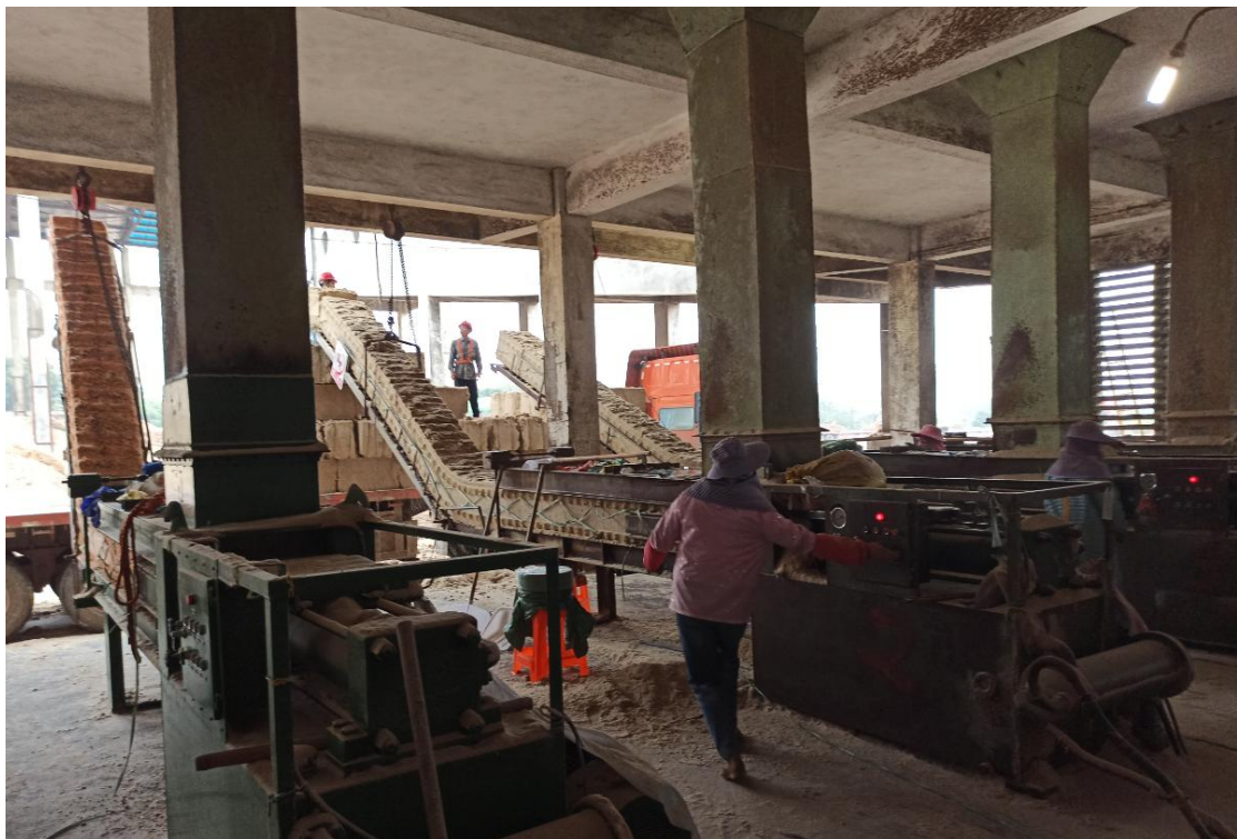
图 9：蔗渣打包车间液压打包、推送装置
