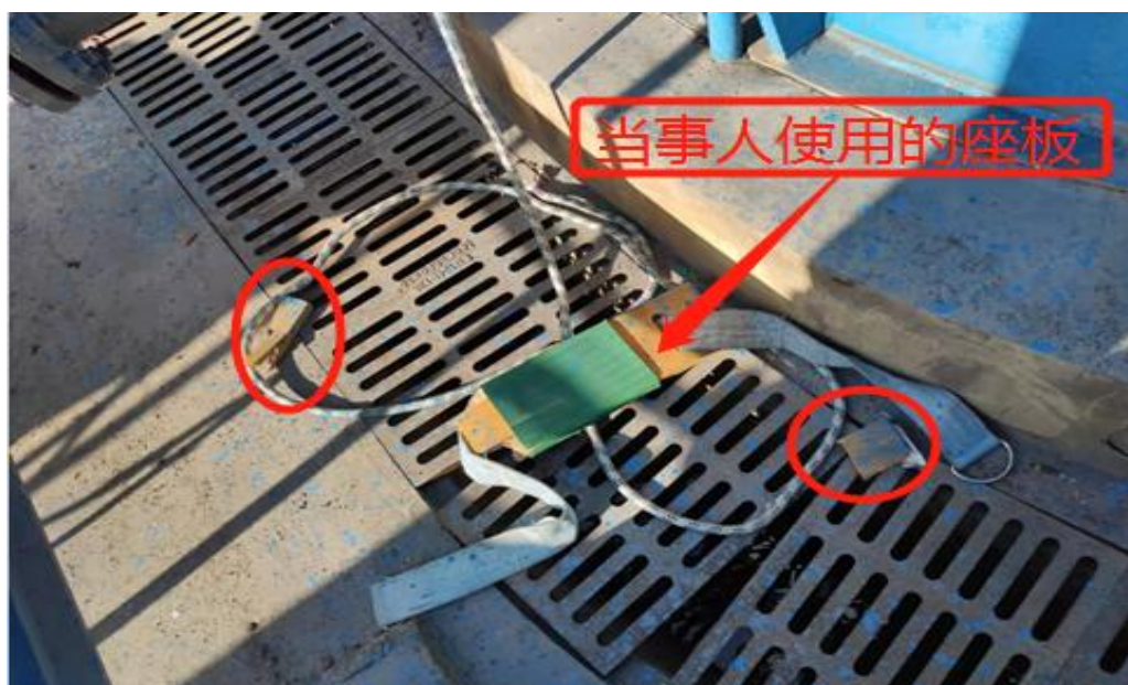
图 2 事发时摔碎的座板式单人吊具
