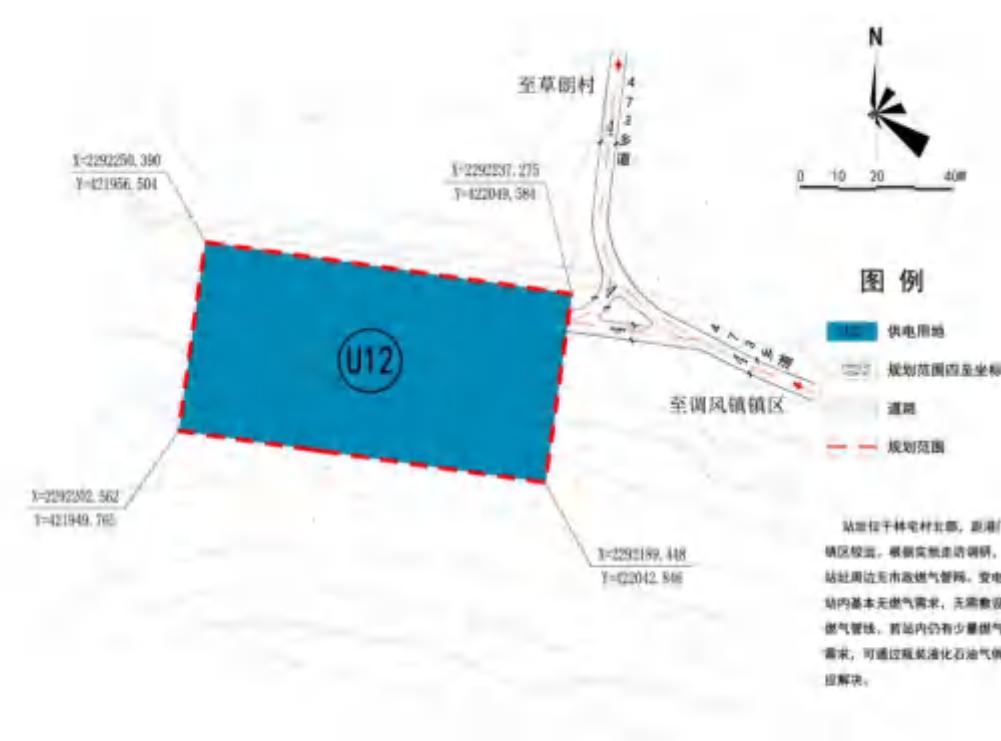
图 12.6-1：燃气工程规划图
