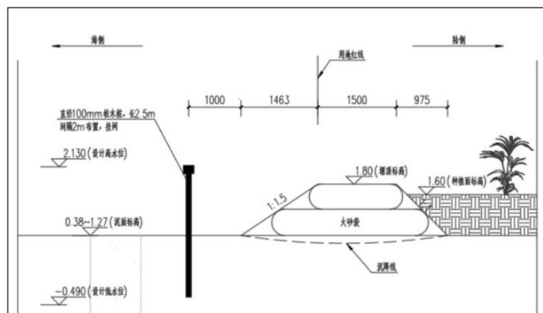
图 2-7 护土措施典型断面图
