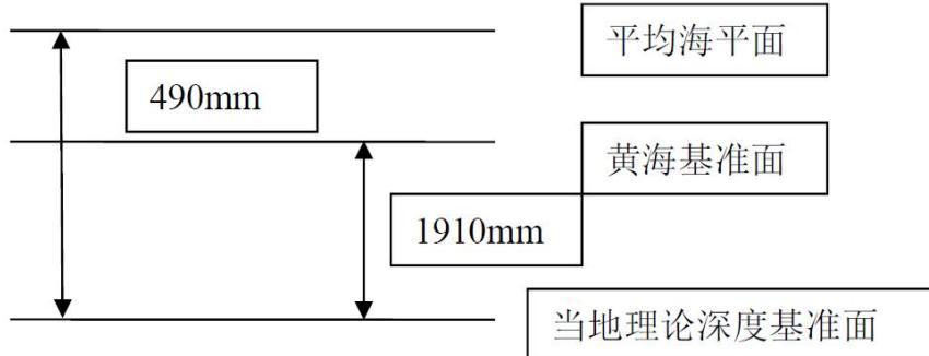
**图 3.1.2-1 各基准面换算关系**
