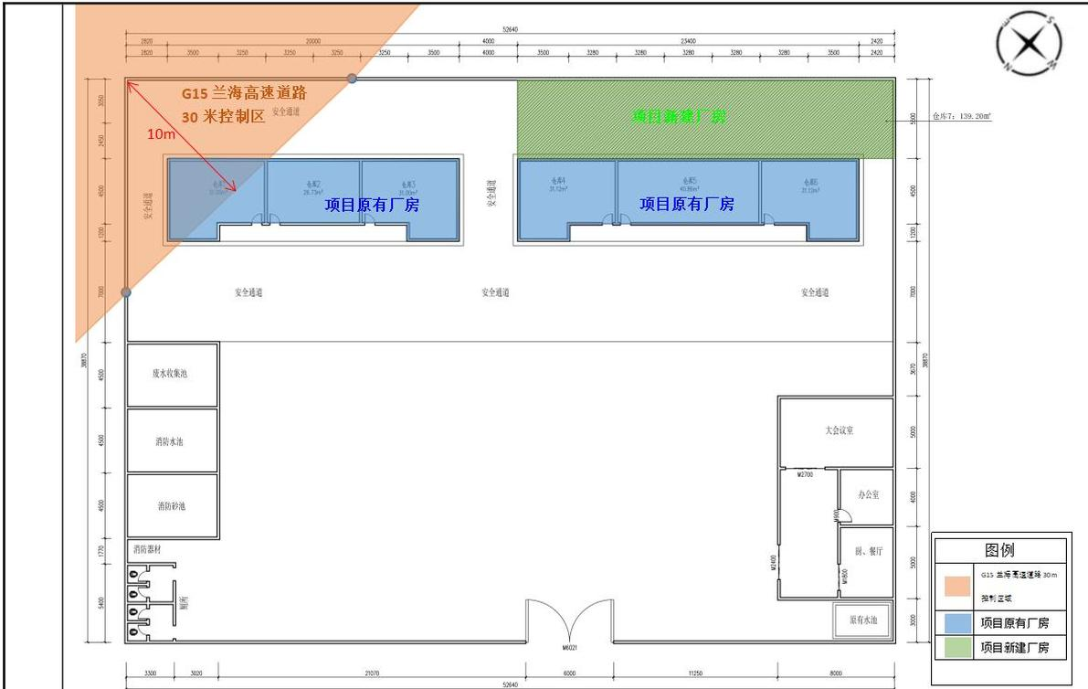
图1-15 项目平面布置图与G15兰海高速公路30米控制区范围关系图
