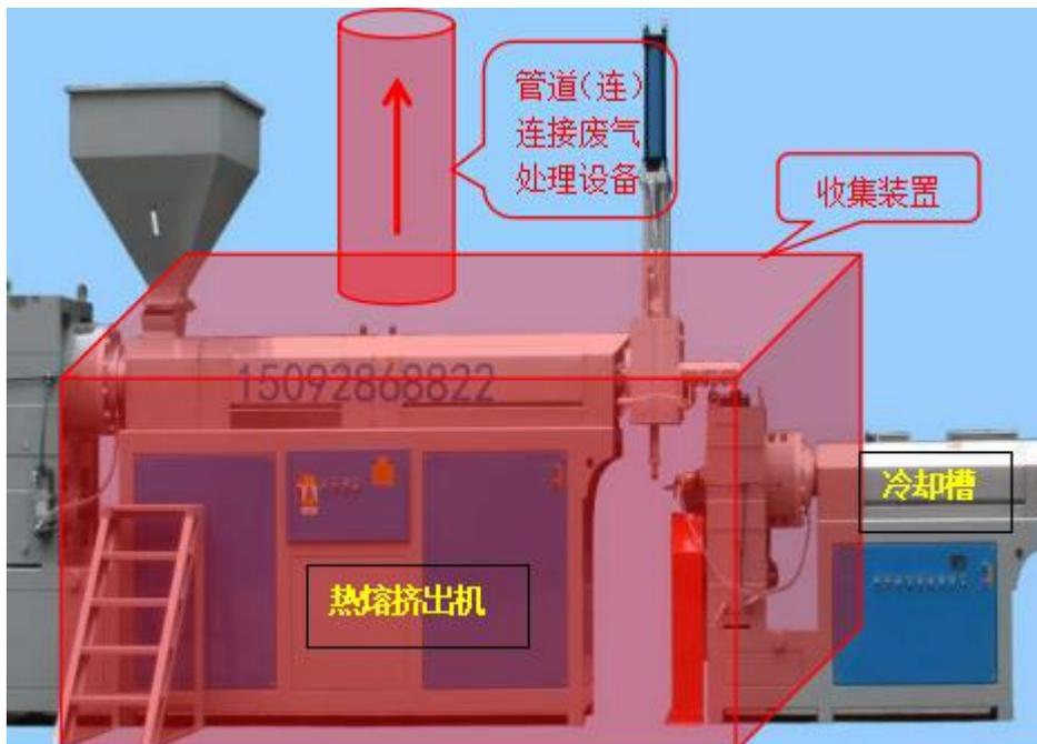
图 4-1 废气密封收集装置
