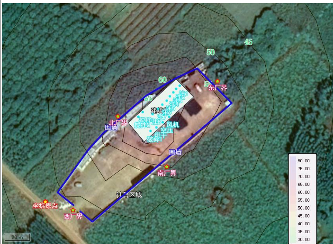
图 4-4 本项目噪声预测示意图 噪声源影响预测值见下表 4-18。
