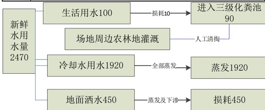
图 2-2 本项目水平衡图 (t/a)
