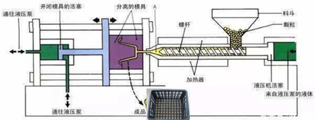
图 2-4 注塑流程示意图
