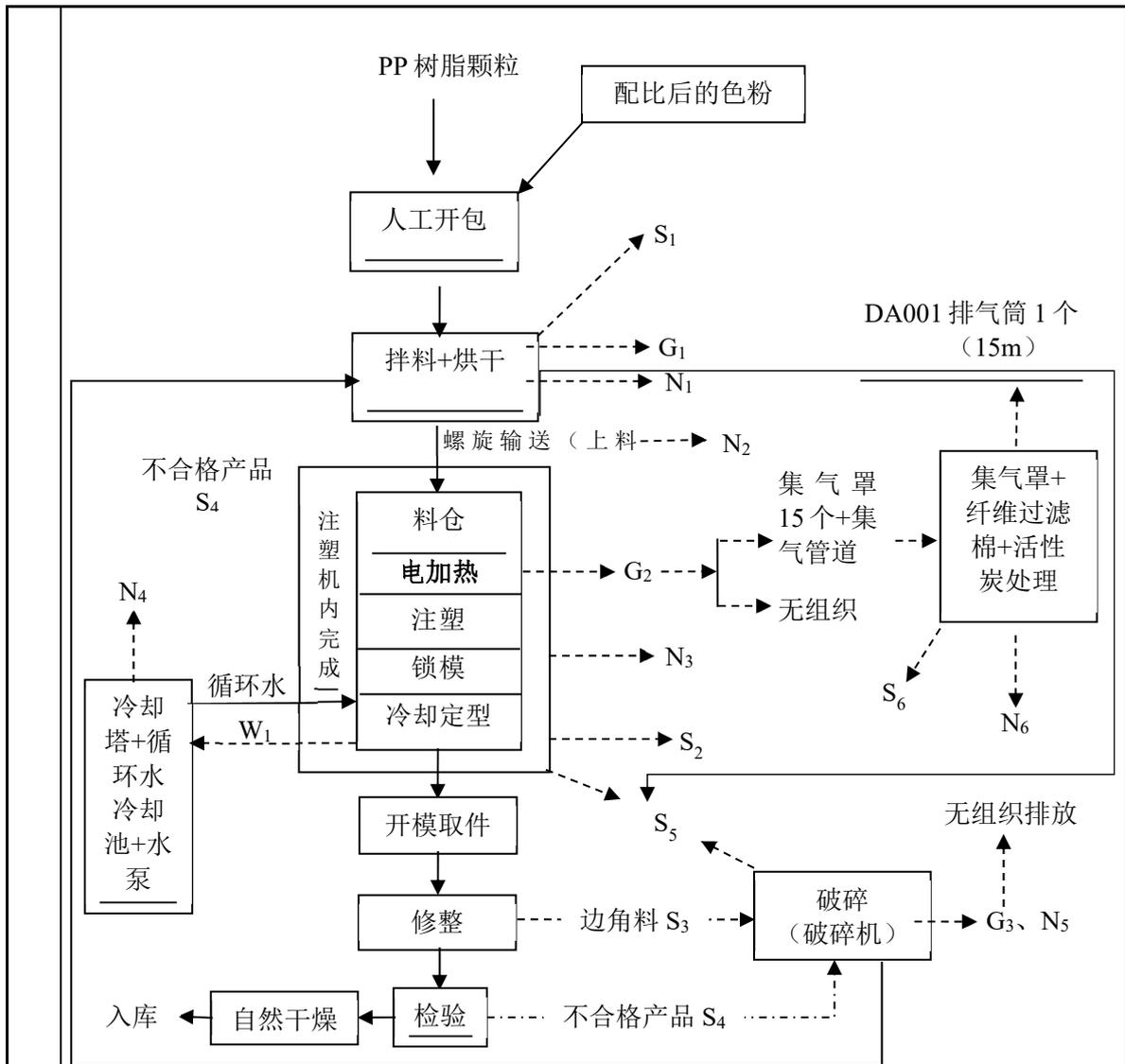
图 2-3 本项目生产工艺流程图
