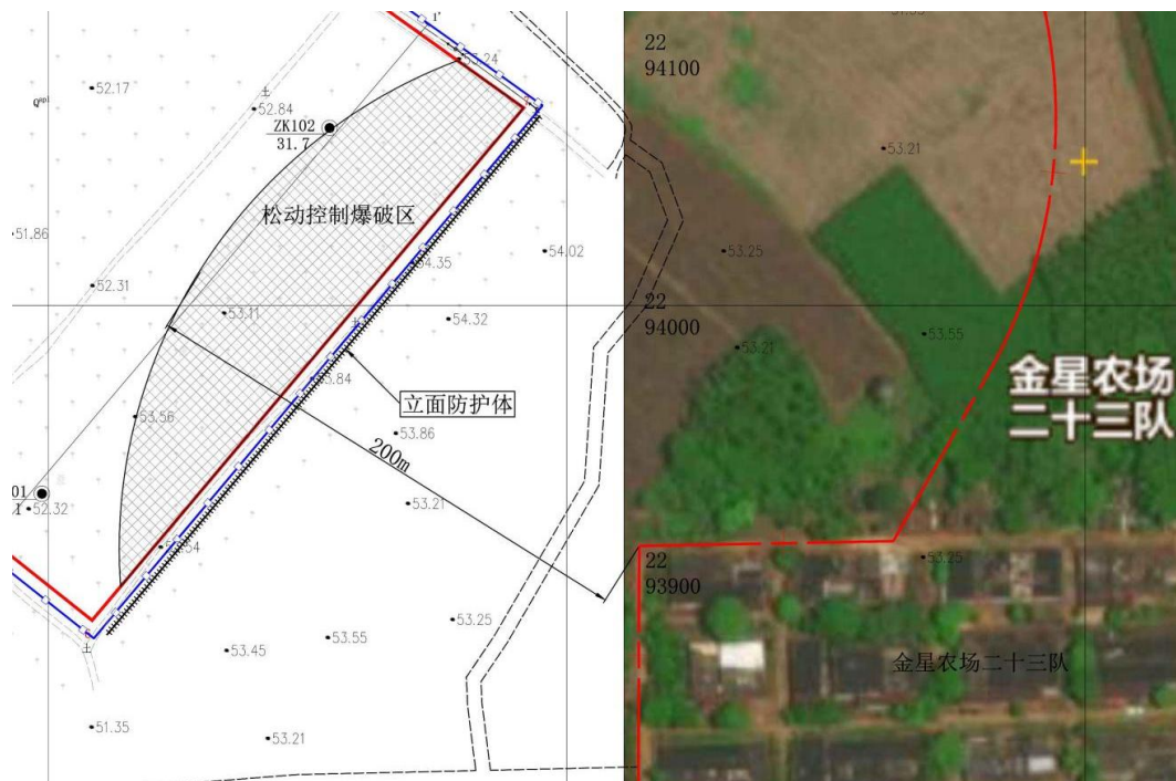
图2-5 爆破作业安全技术设计及立面防护平面示意图（摘自《开发利用方案（修编）》）
