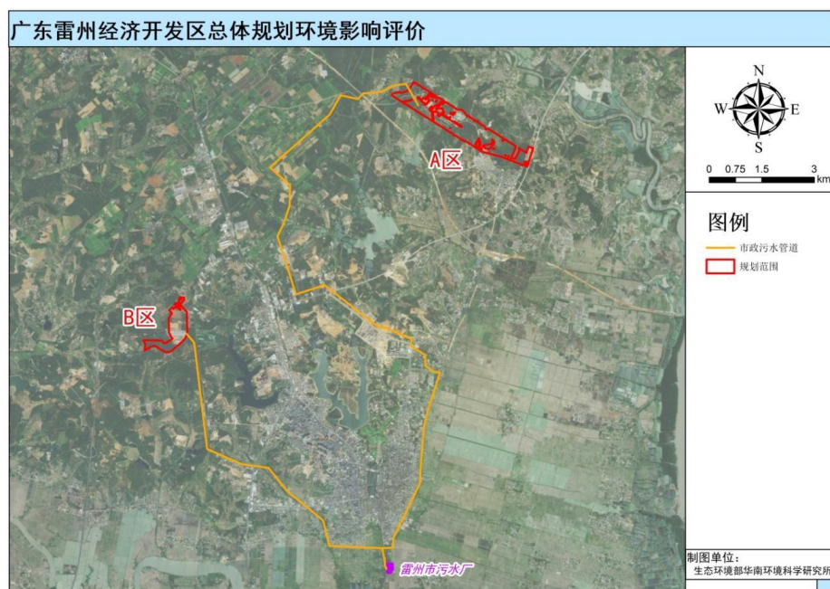
图 2.3-1 A、B 区与市政污水管道接驳示意图
