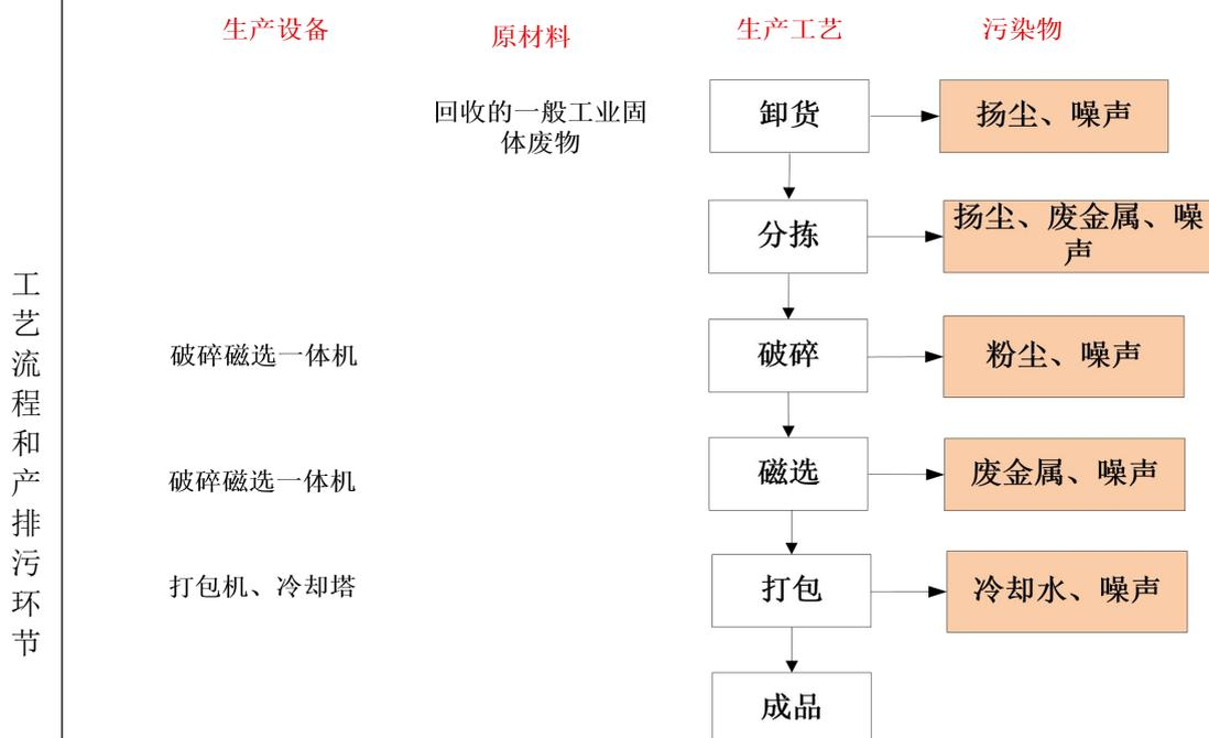
图 2-3 工艺流程图
