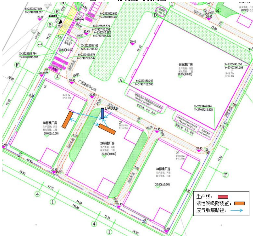
图4-6 楼顶有机废气收集图
