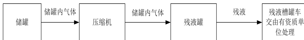
图 2-4 残液罐残液运出回收工艺流程图
