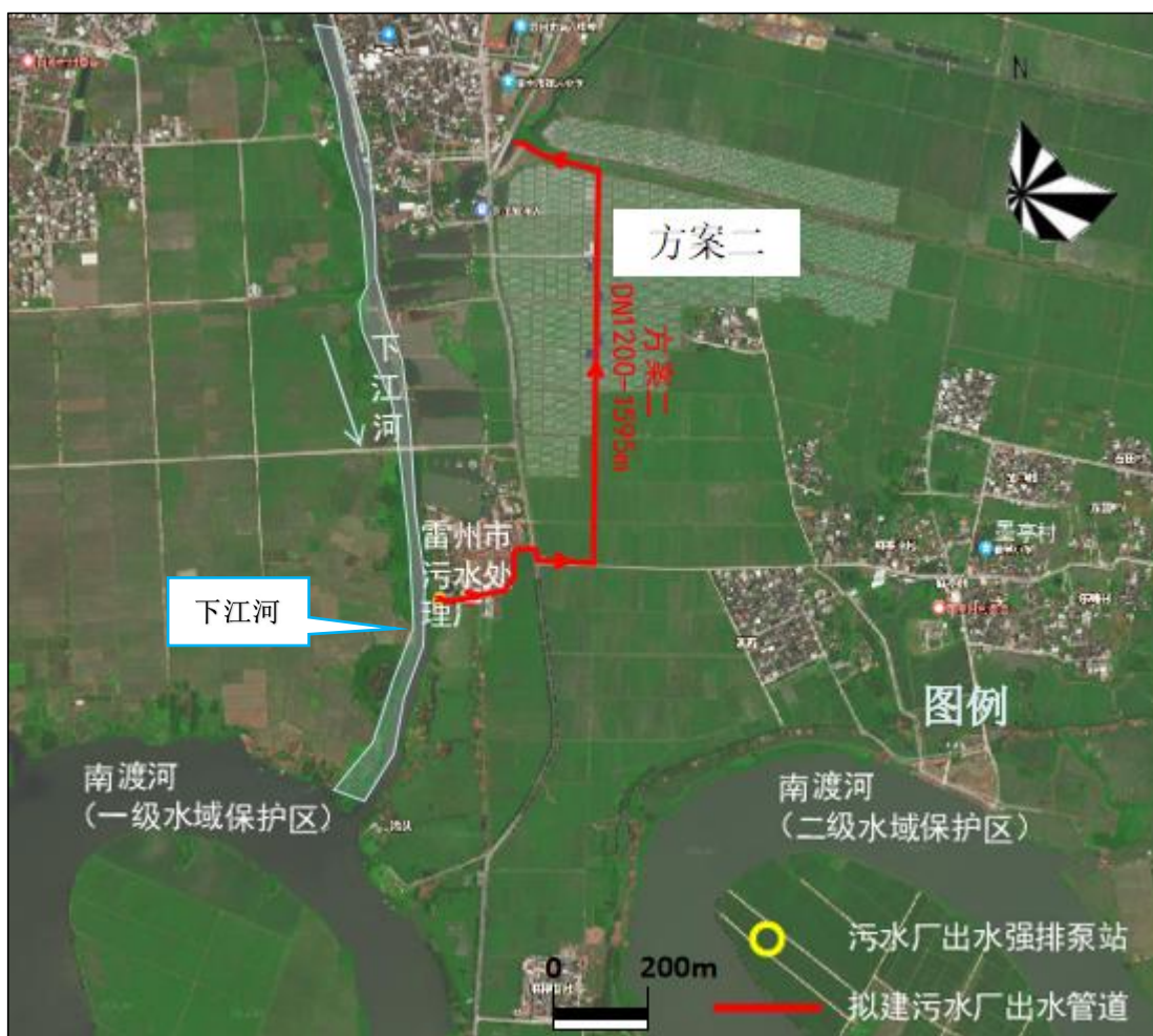
图 5.4-2 入河排污口设置改设方案二示意图
