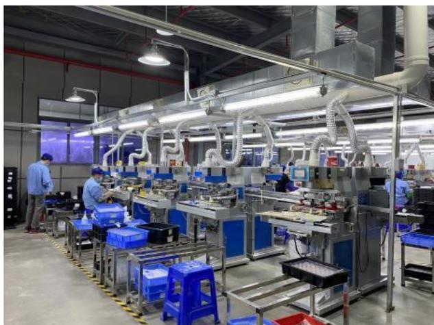
图2.2-14 移印废气收集方式示意图
