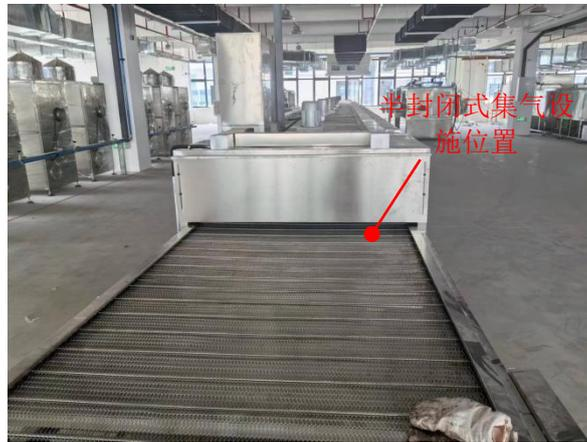
图2.2-17 隧道炉烤箱集气方式示意图
