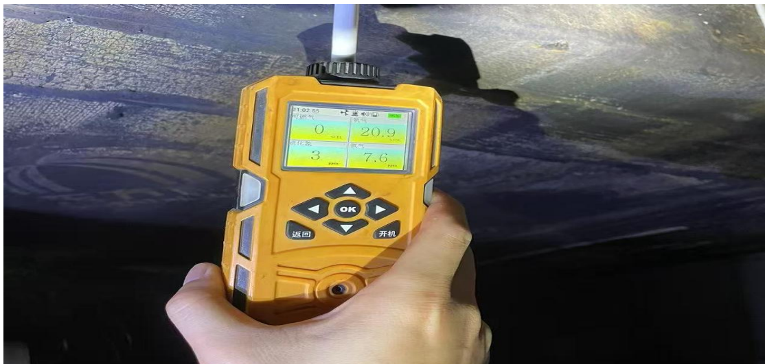
图 11 扩散式四合一检测仪检测硫化氢及氨气含量值
