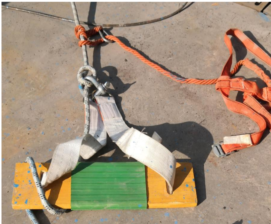
图 3 作业工人演示的单人悬吊座板、安全绳系挂方式
