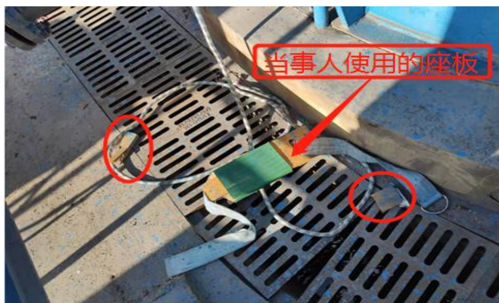
图 2 事发时摔碎的座板式单人吊具
