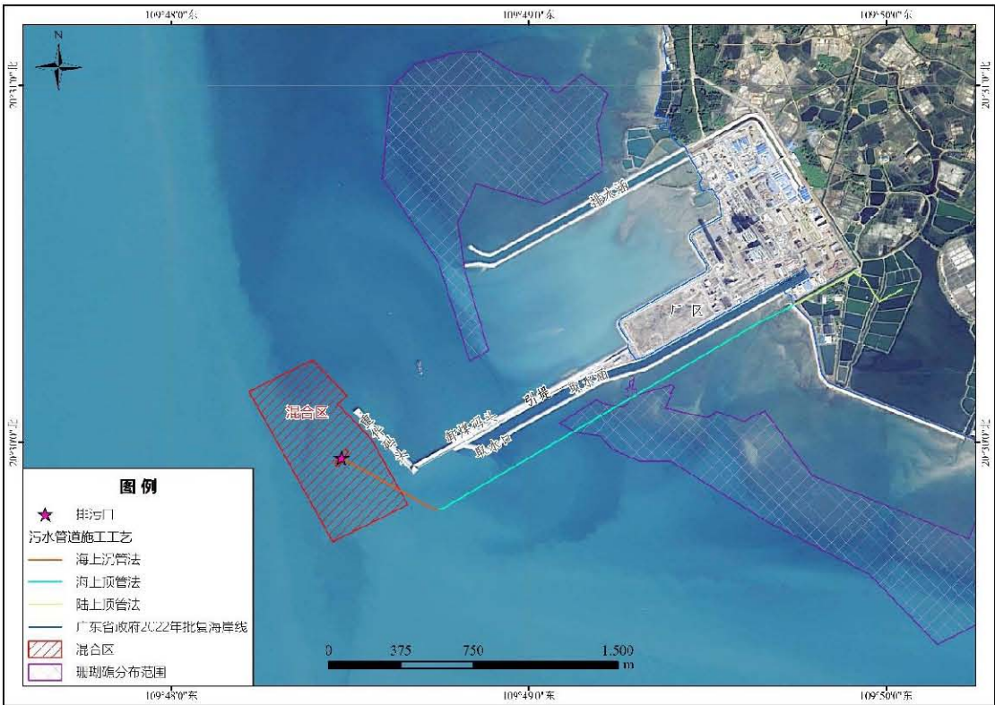
图 6.8.1.3-8 工程顶管法施工段与珊瑚礁分布区位置关系图
