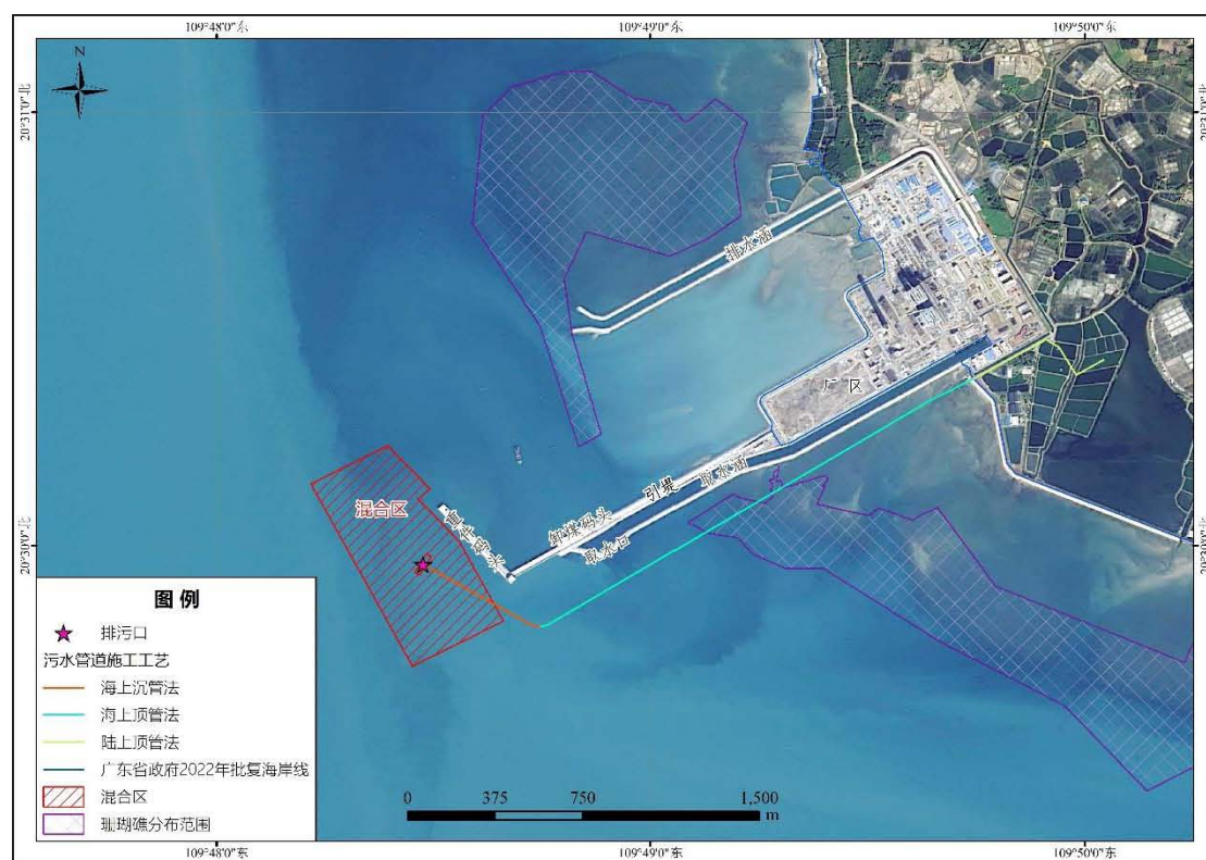
图 3.8-1 拟建污水管道施工工艺示意图
