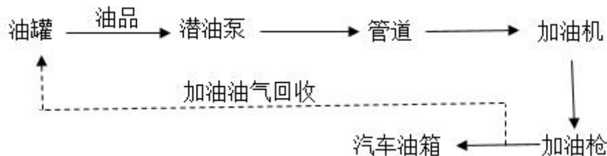
图 5-3 加油工艺流程图
