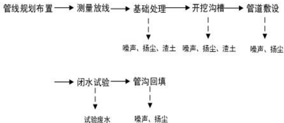
图6 项目配套污水管网工程工艺流程及产污环节
