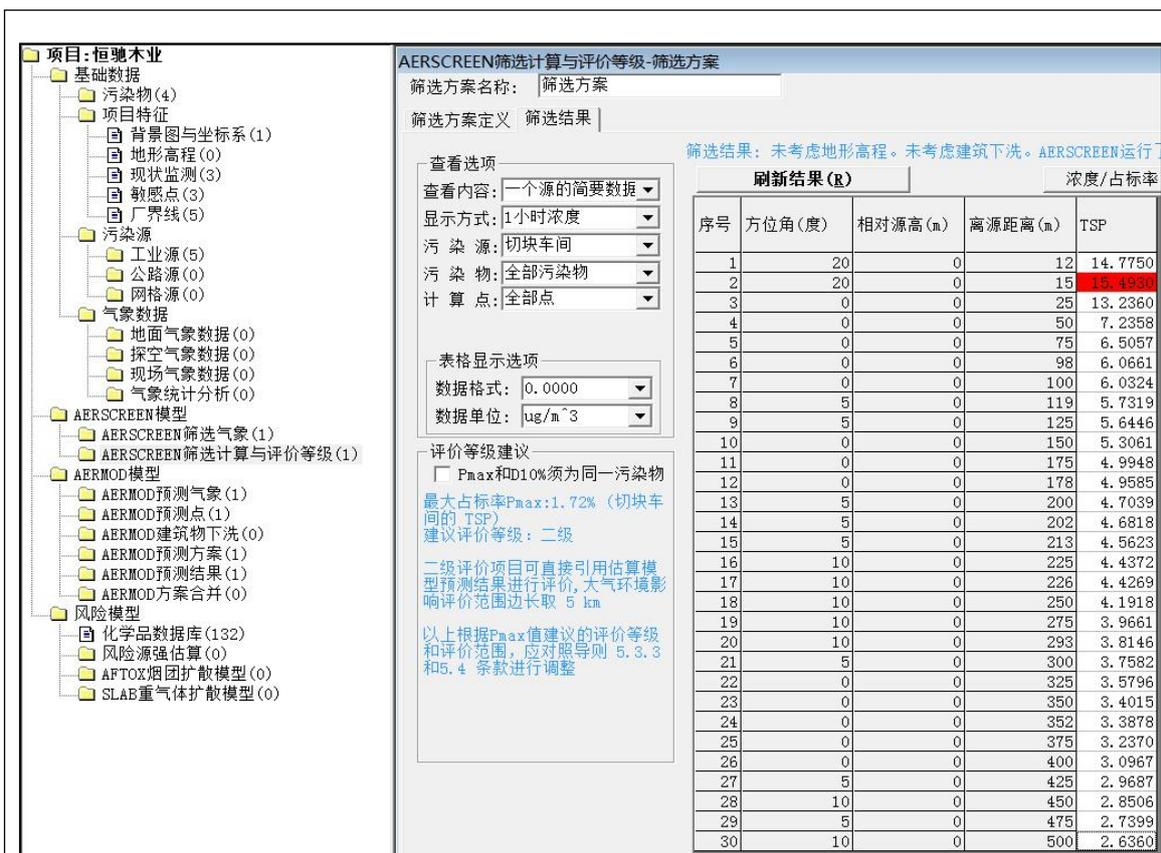
图 6-3 项目切块车间（面源）最大地面空气质量浓度  $C_{\max}$  估算结果
