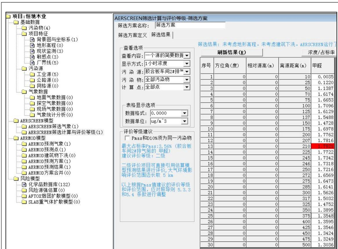
图 6-7 项目胶合板车间 2#排气筒（点源）最大地面空气质量浓度  $C_{max}$  估算结果
