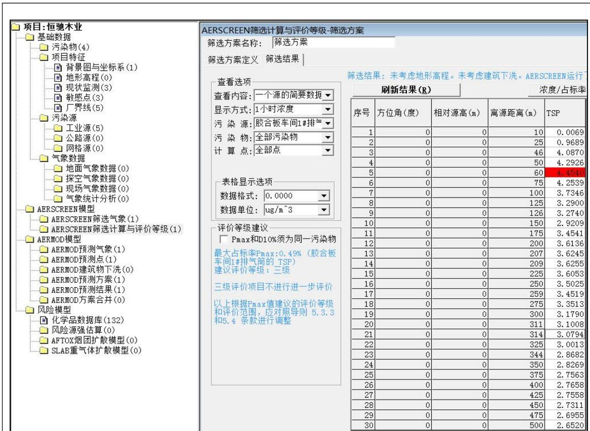
图 6-5 项目胶合板车间 1#排气筒 (点源) 最大地面空气质量浓度  $C_{max}$  估算结果
