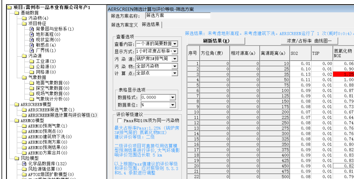
图 6-6 项目锅炉房 3#排气筒（点源）最大占标率 P_{\text{max}} 估算结果
