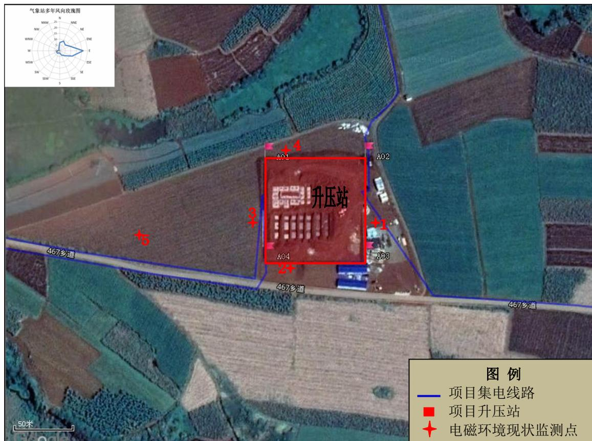
图 5.1-1 电磁辐射监测布点图
