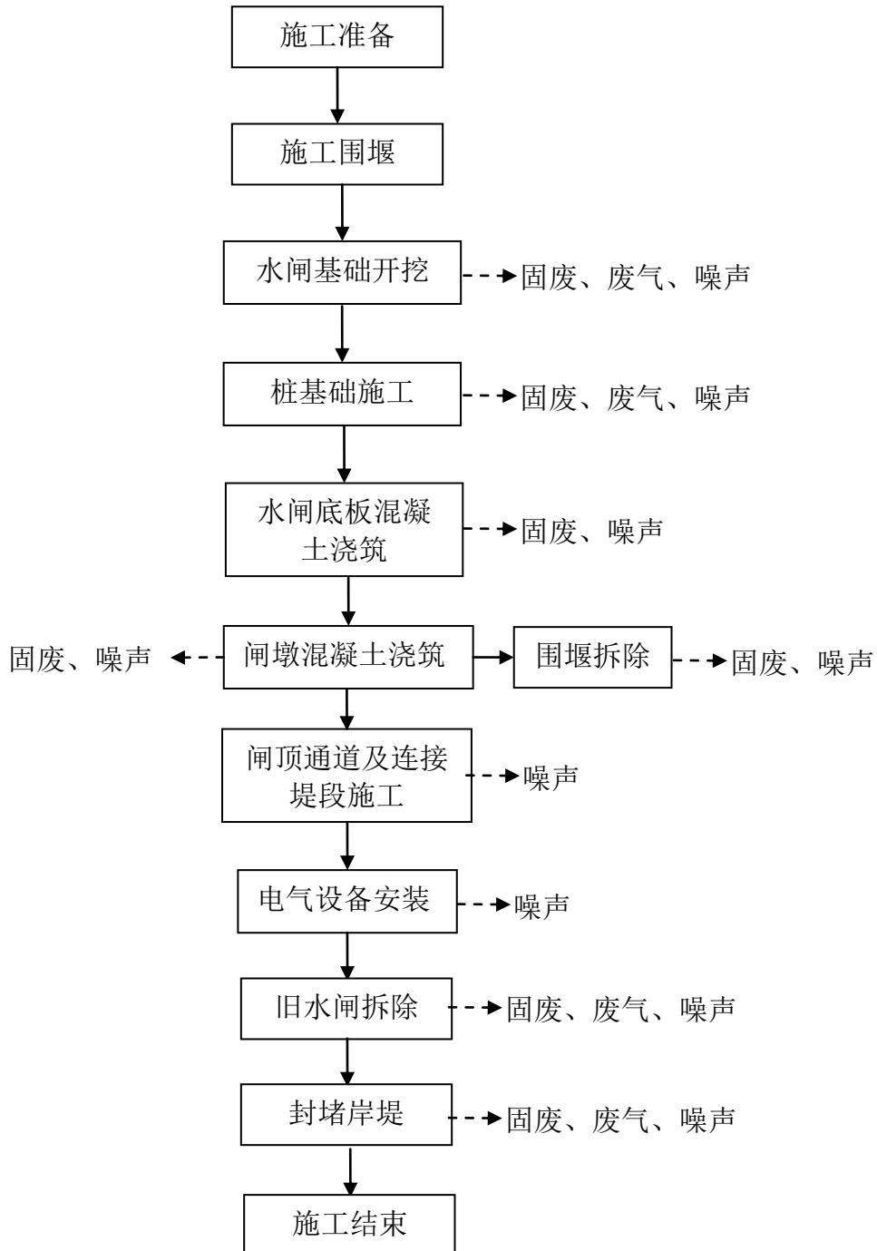
图 2 项目施工期工艺流程图
