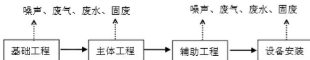
图1 工艺流程及产污环节示意图
