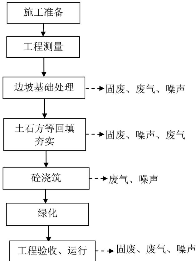
图 5 项目施工期工艺流程图
