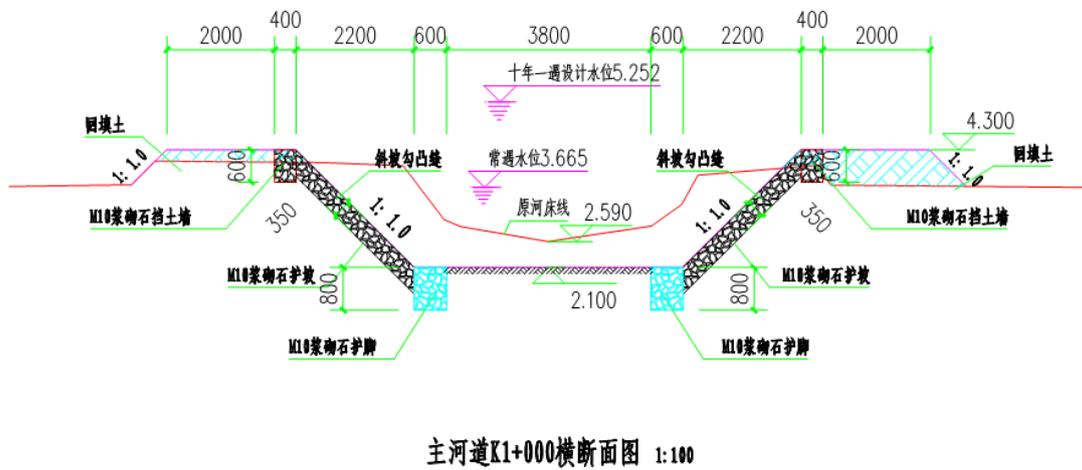
图 1 项目设计堤防典型断面图
