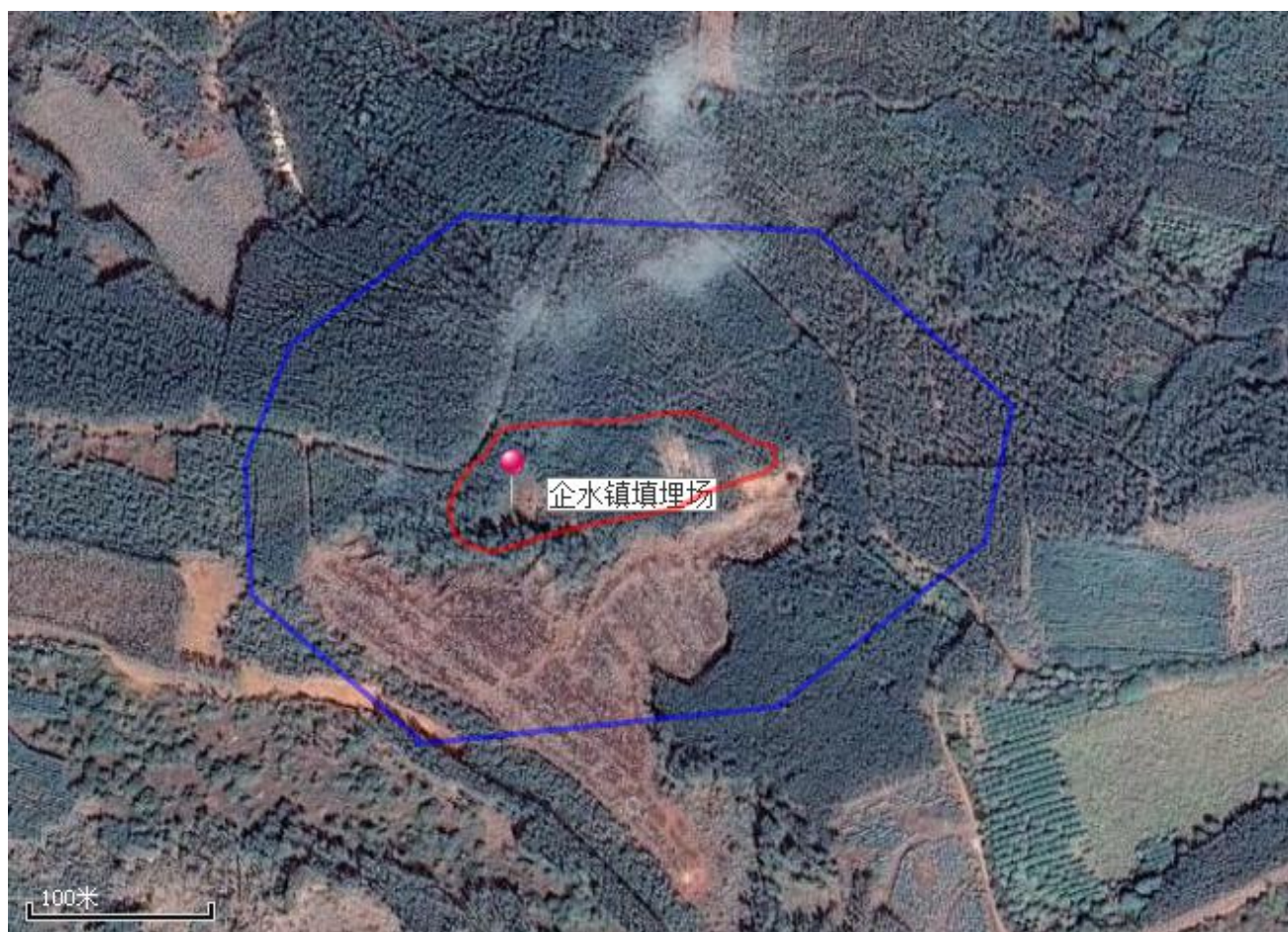
图 7-5 本项目卫生防护距离示意图（蓝色范围为卫生防护距离）
