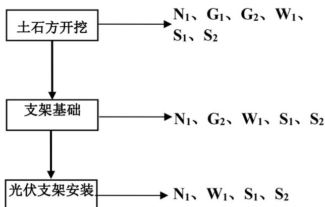
图 5-1 施工阶段生产工艺流程及产污示意图
