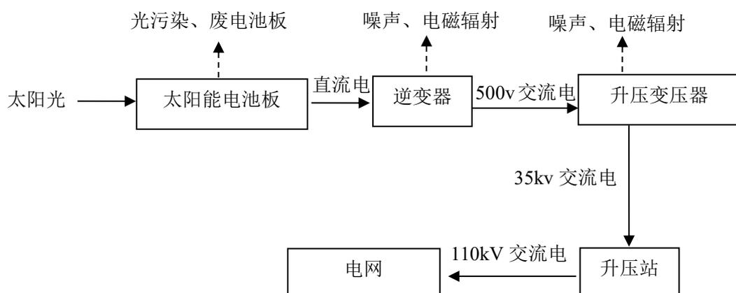
图 5-3 发电工艺流程图
