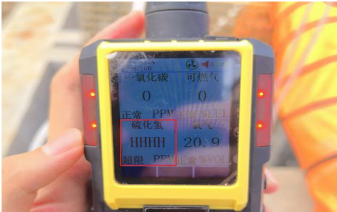
图 9 泵吸式四合一检测仪检测硫化氢含量超限值无法正常显示
